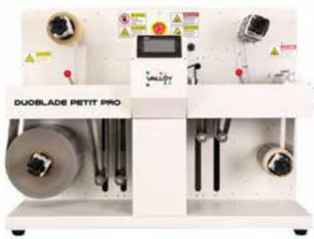
Un modèle de table compact avec de nombreuses fonctionnalités d'une machine de découpe numérique professionnelle : laminage, découpe, extraction de la matrice, fendage et rembobinage. Grâce à son servomoteur à rotation continu et à sa construction robuste, vous pouvez obtenir une grande précision de découpe et un résultat parfait. La largeur maximale du support est de 240 mm permettant la production d'étiquettes jusqu'à 230x300mm.
